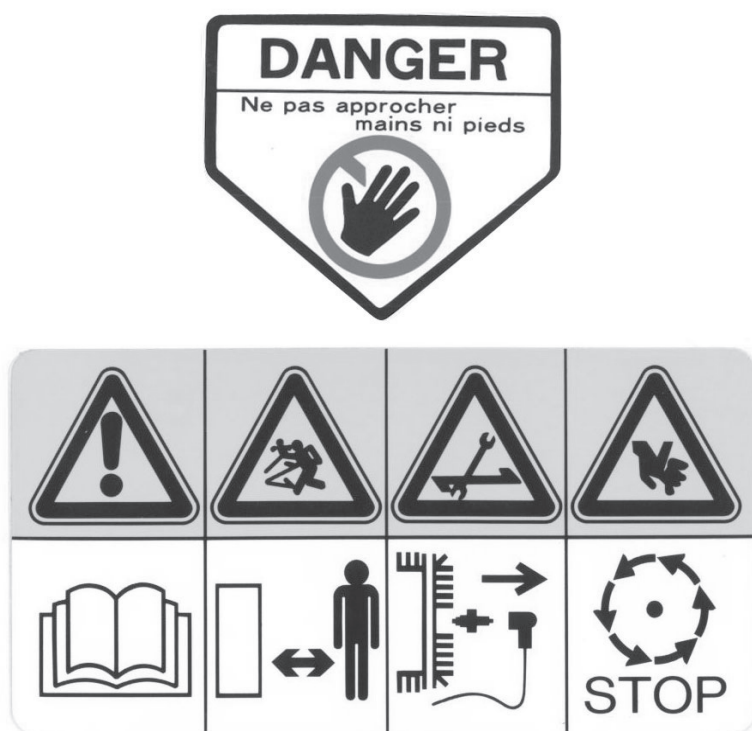
OBR. 1 Bezpečnostná nálepka nachádzajúca sa na kosačke.
